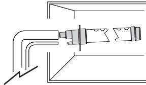
DP\*: линейный парораспределитель (вх. Ø 22 мм, Ø 30 мм, Ø 40 мм)
