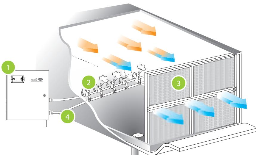
**1** Увлажнитель: различается по моделям в зависимости от максимальной производительности, типа управления (включение/выключение или модуляция), типа используемой воды, мастера/ведомого и электропитания.
